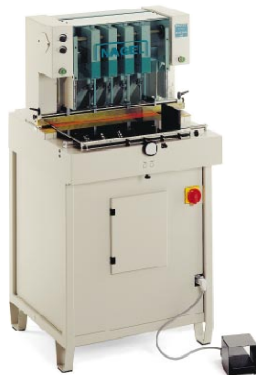
Citoborma 490 con mesa deslizante: el fácil deslizamiento de la mesa garantiza menos esfuerzos a la hora de trabajar.
